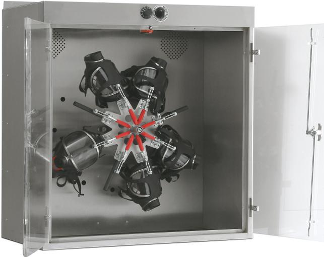
Zweitüriger Maskentrockenschrank aus Edelstahl mit Türverriegelung zum Trocknen von bis zu 9 Atemschutzmasken. Durch das ständige Drehen der Atemschutzmasken wird eine effiziente und schonende Trocknung gewährleistet. Je nach Umgebungstemperatur wird die Trockenzeit zwischen 15 und 30 Minuten angegeben.
