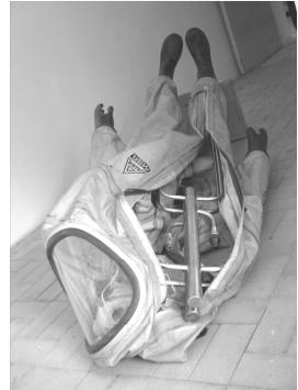
3. Waschlanze des HT-302A / HT-303-A / HT-304-A entnehmen und in den Anzug (Arme und Beine) am Boden (Tisch) liegend einschieben.
